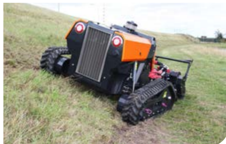
Unabhängig pendelbare Raupen für optimale Bodenverfolgung und optimalen Griff
