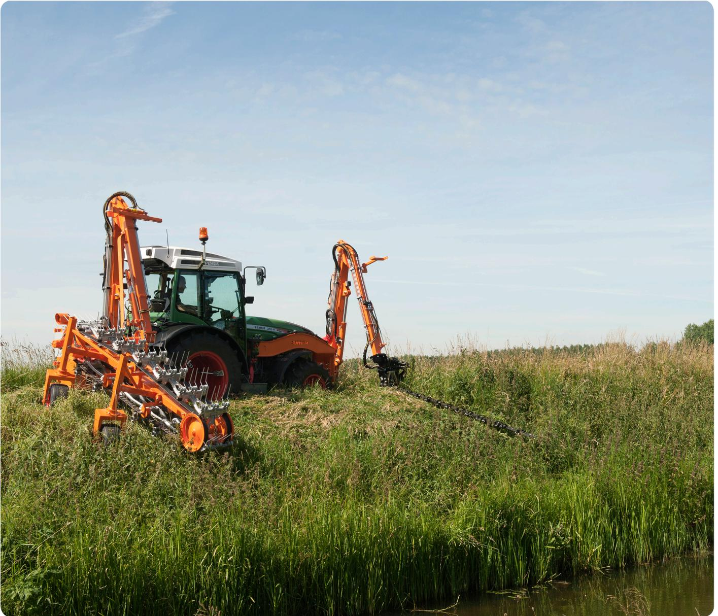
Die gesamte Grabenpflege von einem Pfad aus in nur einem Arbeitsgang auf die ökologisch vorteilhafteste Weise erledigen? Das ist mit der Mäh-/Harkkombination C36 von Conver schnell und einfach möglich. Angesichts dieser Wahlmöglichkeiten können Sie für die unterschiedlichsten Bedingungen eine passende Maschine zusammenstellen.
