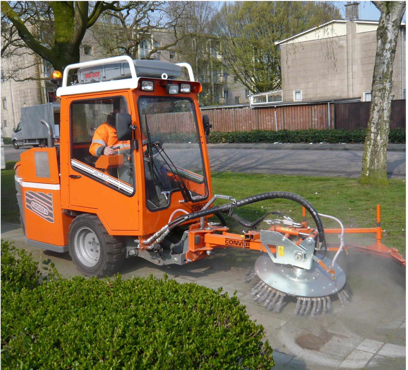
Conver stellt Ihnen die C3 Bürstenmaschine vor. Diese Maschine wurde in enger Zusammenarbeit mit einem der größten Pioniere auf dem Gebiet der Unkrautbürsten entwickelt. Seine Fachkenntnis wurde mit seinem großen Schatz an Erfahrung und hochwertiger Technik kombiniert. So wurde eine Bürstenmaschine auf drei Rädern entwickelt, die sich durch Produktivität und Bedienungskomfort auszeichnet. Diese Maschine ist darüber hinaus äußerst Wartungsfreundlich.
